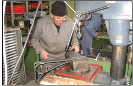
Herstellung der Dachwinkel im Einstiegsbereich
